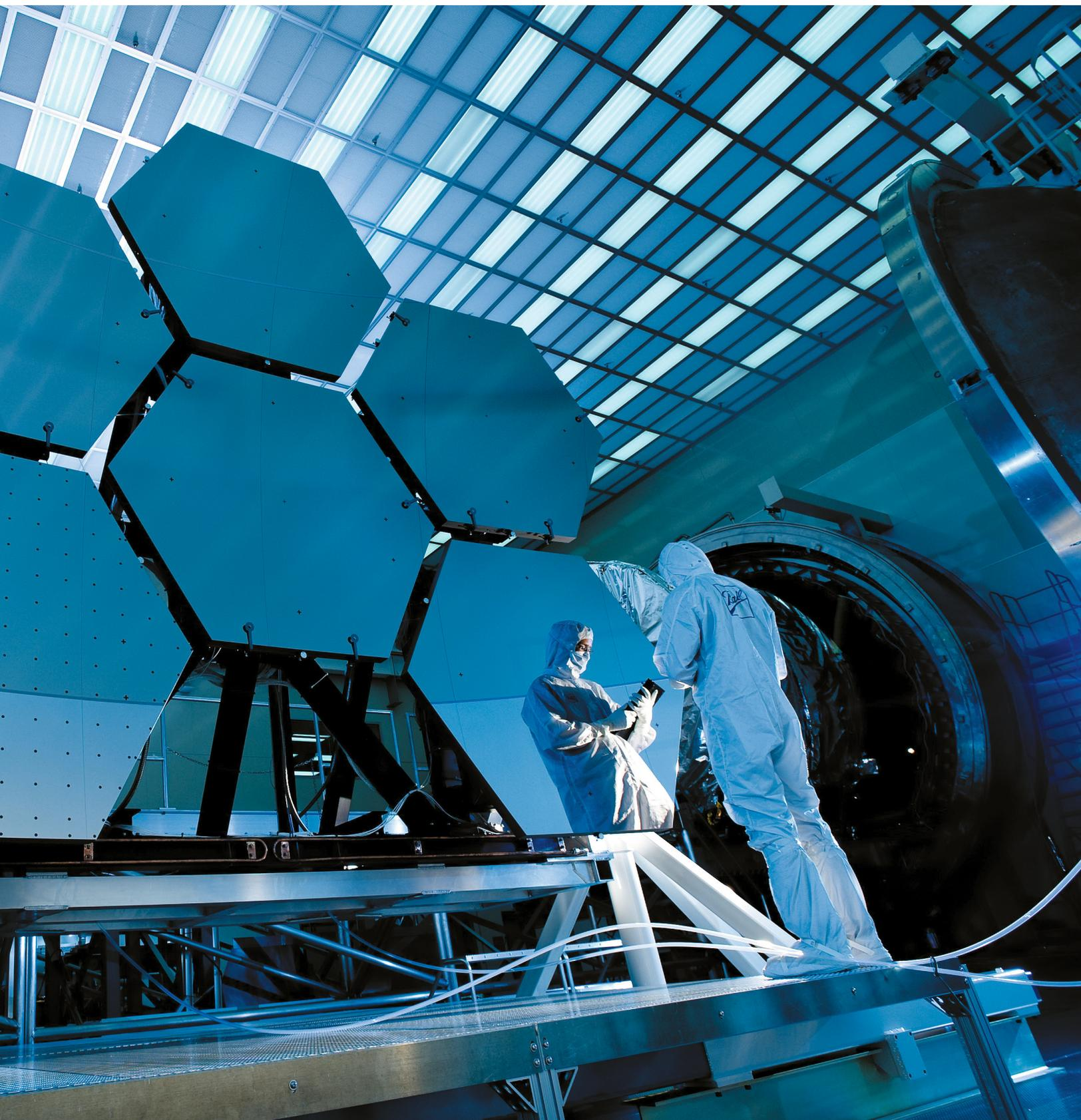
Il gigantesco specchio primario del Webb è composto da diciotto segmenti di forma esagonale. Durante i test, gli specchi sono stati sottoposti a temperature fino a  $-248^{\circ}\text{C}$ .
