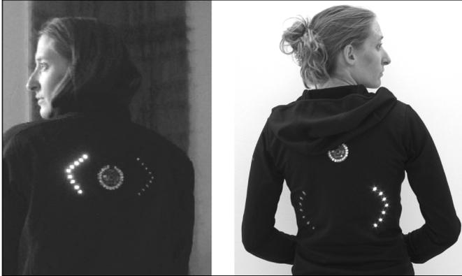
**Figura 1.4** Giubbotto da biking con frecce direzionali, sviluppato con e-tessuti da Leah Beuchley. (Fonte: per gentile conessione di Leah Buechley.)
