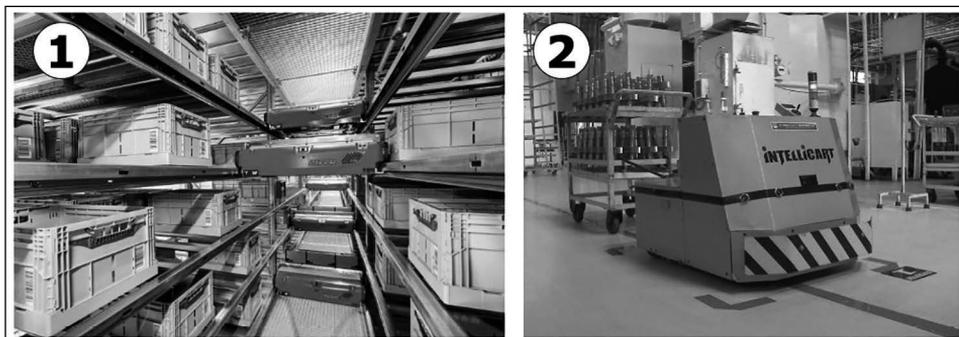
**Figura 1.8** Sistemi robotici da magazzino: Stingray di TGWmechanics [CC BY-SA 3.0 (<https://creativecommons.org/licenses/by-sa/3.0/>)] e Intellicart di Mukeshhrs (pubblico dominio).
