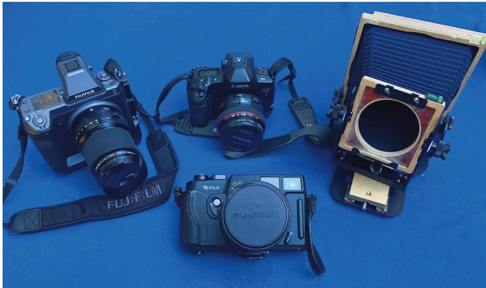
**Figura 1.1** Fotocamere analogiche e digitali in vari formati: 35mm Canon Eos 3 analogica, 44x33 Fujifilm GFX 100 medio formato digitale, 6x9 Fujifilm GSW690III medio formato analogico e 10x12 (4x5") Intrepid Camera MK4 banco analogico.
