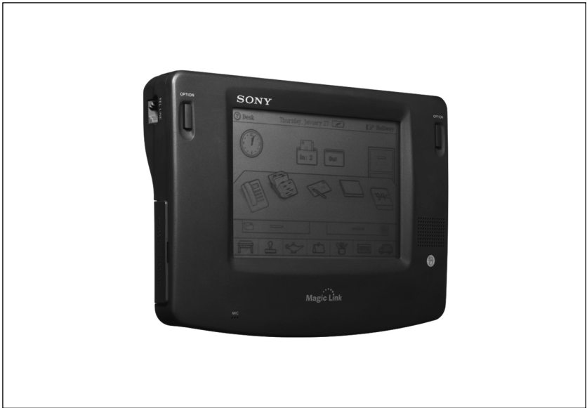
Figura 1.1 Il Magic Link era in vendita a 800 dollari, pesava quasi 800 grammi e misurava ben 7,7 \times 5,6 pollici (circa 19,8 \times 14,2 cm). Aveva un telefono, uno schermo touch, email, possibilità di scaricare app, giochi, un modo per acquistare biglietti aerei, emoji animate e una tecnologia rivoluzionaria infilata dappertutto. Un po' come l'iPhone.
