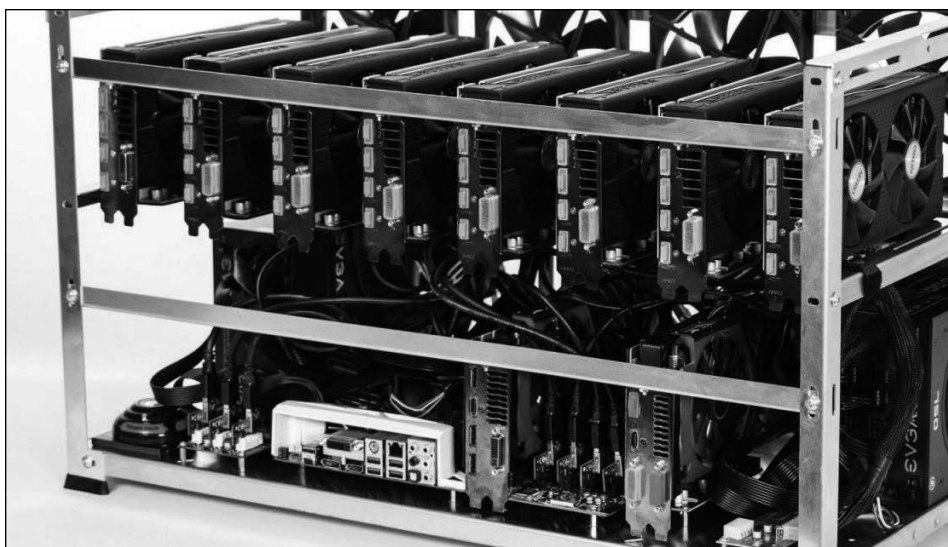
Figura 1.3 Per eseguire i calcoli necessari per “acquisire” criptovalute si usano strane macchine, composte da una normale scheda madre e una grande quantità di schede video di elevata potenza.
