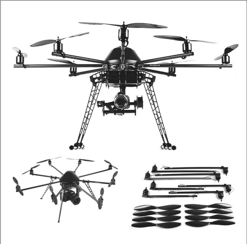
**Figura 1.21** Il drone Mikrokopter MK EASY Okto XL2 4S e i component base del kit di montaggio.
