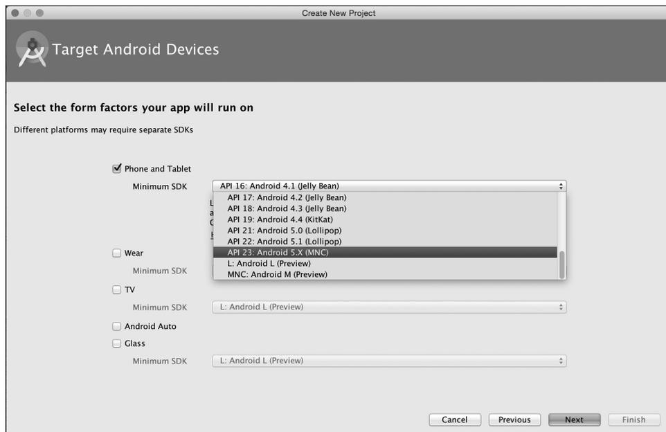
**Figura 2.3** Selezione della versione minima di SDK supportata.
