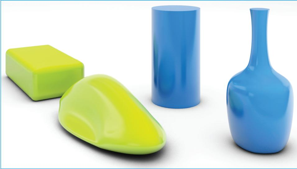
**Figura 4.11** Nell'immagine sono rappresentati due oggetti ottenuti attraverso l'utilizzo del modificatore FFD. Il parallelepipedo è stato deformato attraverso una griglia di tipo Box, il cilindro con una di tipo Cyl.
