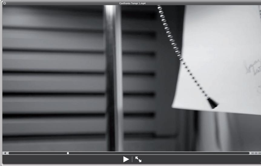
**Figura 1.25** La stessa immagine con un tempo di esposizione di  $1/250$ : il movimento appare meno fluido, ma quando mettiamo in pausa il fotogramma la catenella è molto più nitida, ovvero congelata.
