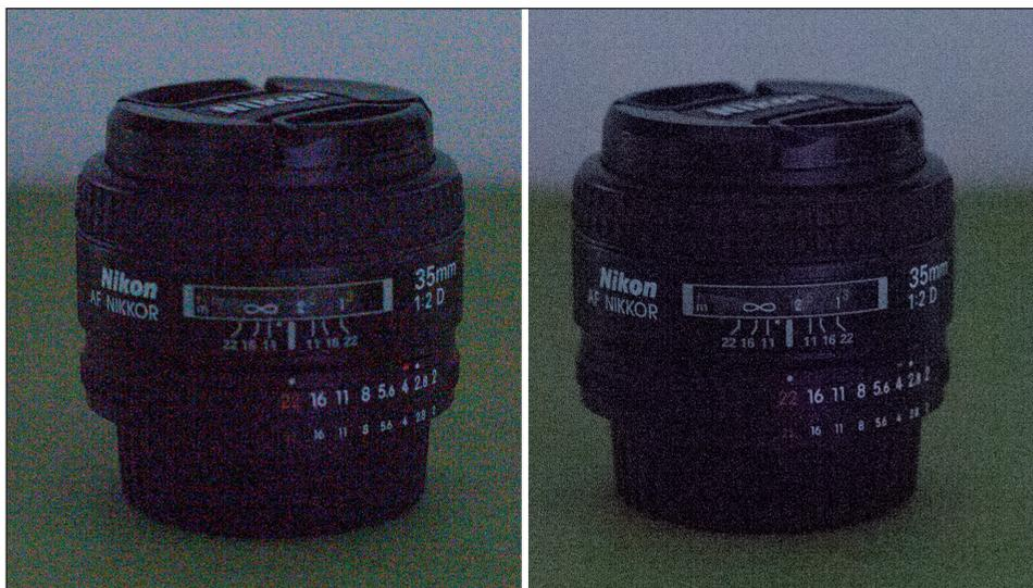
**Figura 1.29** Rumore di cromaticanza (a sinistra) e di luminanza (a destra).
