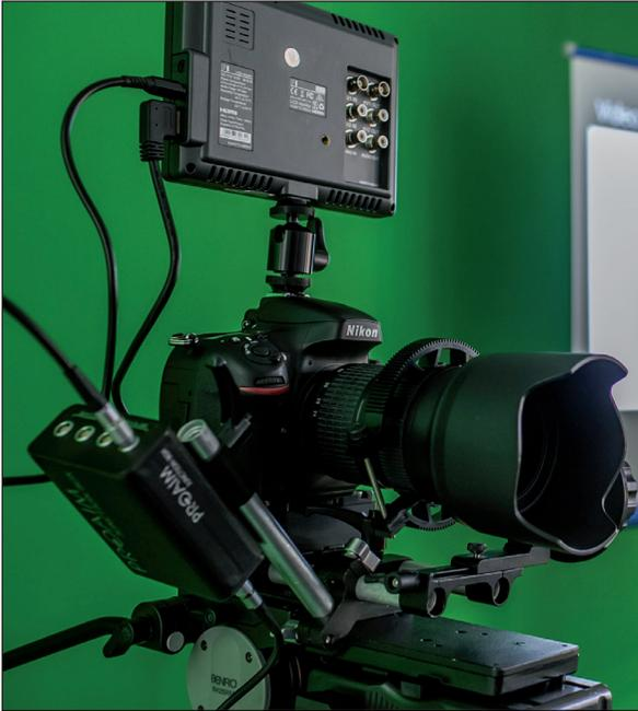
**Figura 1.10** Una Nikon D800 “carrozzata” completamente in modalità video reflex. Tutti gli accessori vengono assemblati a una struttura tubolare portante.
