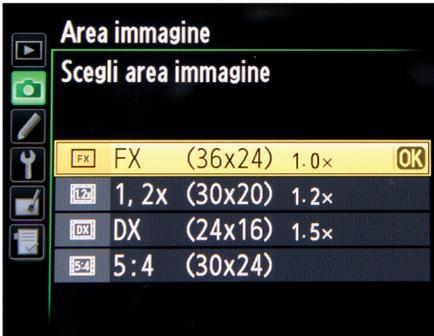
**Figura 1.8** Menu per la scelta dell'area di crop in funzione dell'ottica installata su Nikon D800.
