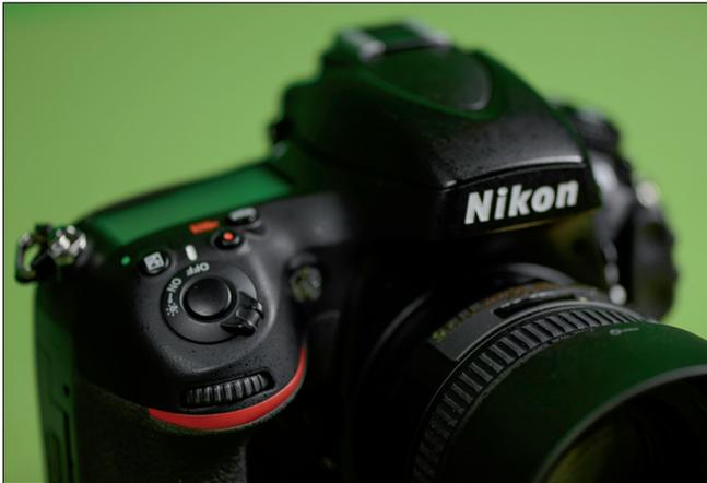
**Figura 1.13** Una delle due ghiera che possono essere utilizzate per il controllo del diaframma su una Nikon D800.
